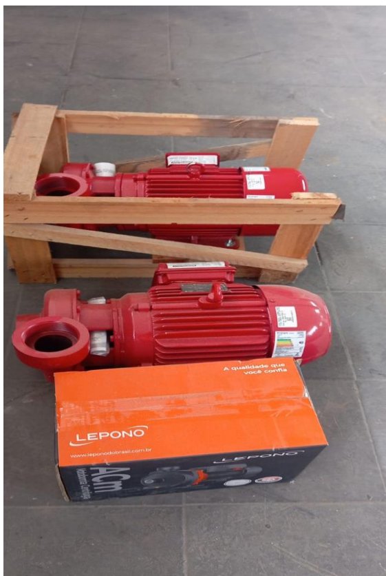
Figura 6 - Bombas de Incêndio.
